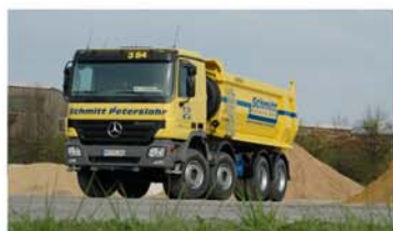
Zum Fuhrpark gehören Zwei-Achs Sattelzugmaschinen mit Alu-/Stahlmulden, Drei-Achs Sattelzugmaschinen mit Stahlmulden und Drei-Seiten-Kippern, Drei-Achs-Kipper mit Tandemhänger sowie Vier-Achs-Kipper Stahlmulden. (Fotos: Schmitt-Peterslahr)
